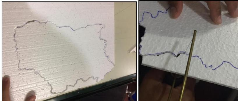
**Ilustrações 05 e 06:** Resultado do desenho do contorno do mapa de curvas de nível em placas de isopor e Recorte dos contornos das camadas do isopor utilizando cortador elétrico.
