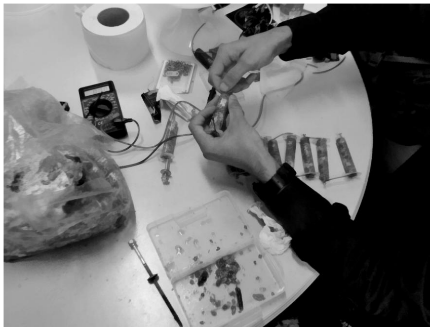
Figura 4: Confeção artesanal de porções de micélio ligadas em cadeia, gerando corrente elétrica. Fonte: autor (Lisboa, 07/11/2022)
