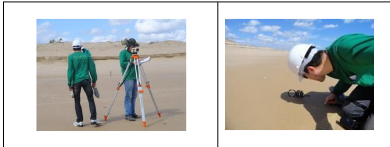
Figura 07 – Metodologias de campo (nivelamento topográfico, a esquerda; e Coleta da declividade do estirâncio, a direita). Fotos: Marcelo Chaves, 2012.
