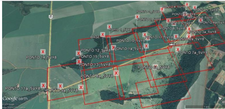
Figura 2. Distribuição espacial dos 10 planos de voos necessários ao recobrimento da área de estudo, com resolução espacial (ou GSD) de 10 cm.
