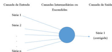
Figura 2 - Estrutura de uma rede neural artificial perceptron multicamada. Fonte: HAYKIN (2008)
