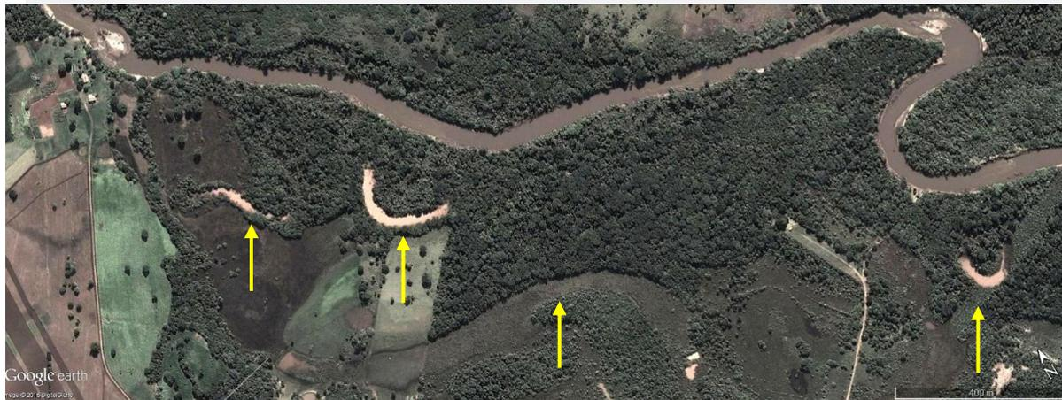
Figura 2 – Exemplo de feições morfológicas relictas do rio Miranda. As setas destacam a presença de canal e meandros abandonados (Imagem Google Earth 20/03/2013). Coordenadas de referência da imagem (Seta no centro da imagem 21°26'50.36"S/ 56° 9'19.07"O).
